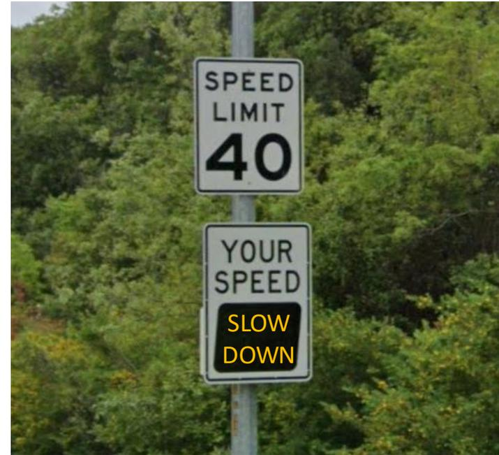
Ejemplo de Señal de Radar de Velocidad
