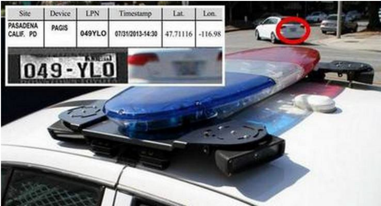
Hình 1: Xe cảnh sát có Đầu Đọc Biển Số Tự Động gắn trên nóc xe và hình ảnh ví dụ từ máy ảnh ALPR (trên cùng bên trái). Ảnh ALPR này xác định 1) biển số xe, 2) thời gian và vị trí chiếc xe, và 3) thông tin khác được chụp trong ảnh, bao gồm màu sắc, kiểu dáng và kiểu xe. Nguồn: Pasadena, Cục Cảnh sát CA:
